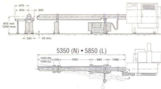
Alimentatore multifascio a 5 o 6 tubi guidabarra, applicabile a torni che lavorano piccole serie con frequenti cambi di diametro di barra.
